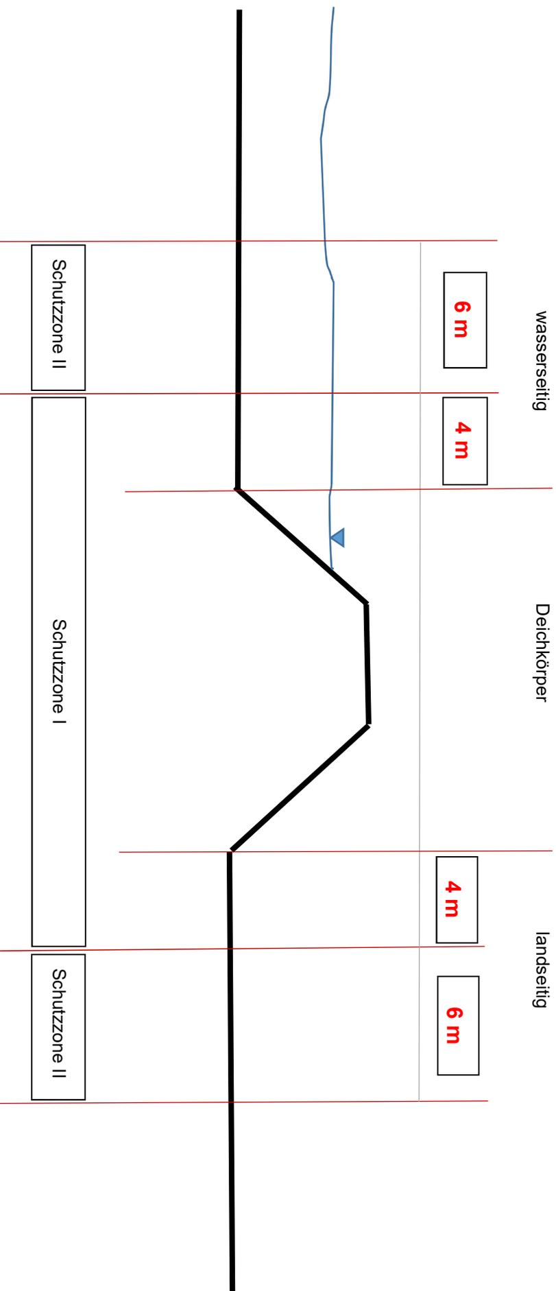
Schutzonen-Prinzipskizze bei Hochwasserschutzanlagen an Gewässern zweiter Ordnung
